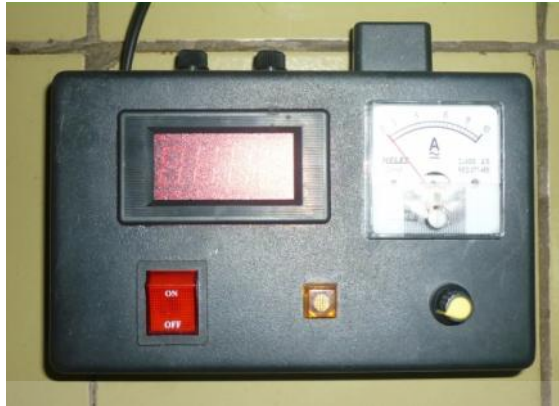
Gambar 3.4 Variable Heater Untuk Test Section
