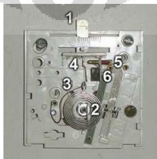
Gambar 2.13 Komponen Dalam Thermostat Sederhana
