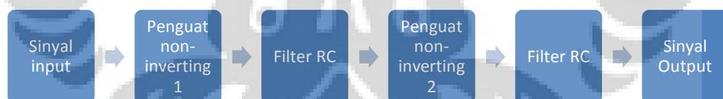
Gambar 3.9 Blok diagram rangkaian penguat
