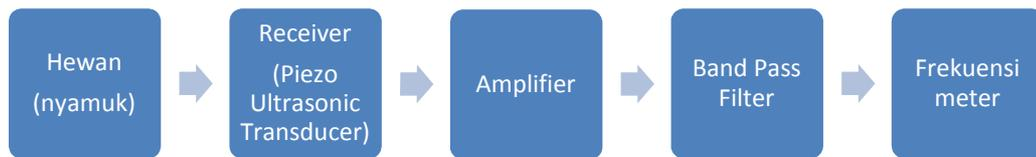
Gambar 3.6 Blok diagram rangkaian pendeteksi nyamuk
