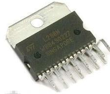
Gambar 2.8 IC Driver Motor L298
