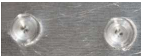
Gambar 4.4 Hasil Pengelasan pada Metode Spot Welding Tidak Terjadi Lubang
