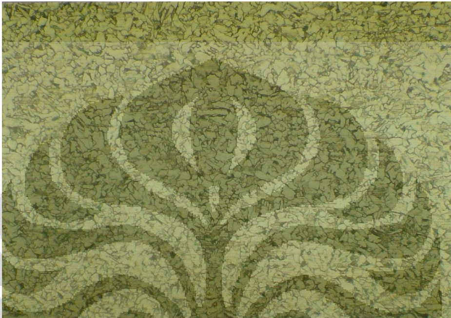
( Struktur mikro daerah logam induk pelat 6 mm )
