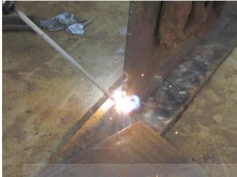
Gambar 3.12 Welding untuk Profil Bulb
