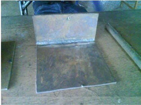
Gambar 3.14 Profil L Marine Buatan
