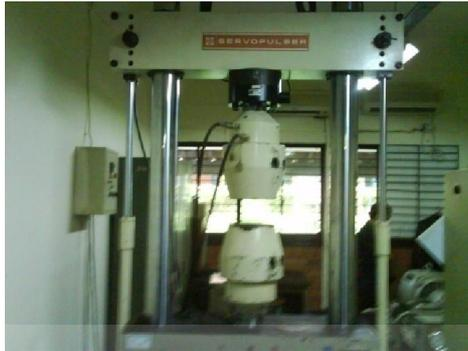
Gambar 3.5 Alat Uji Tarik Servopulser
