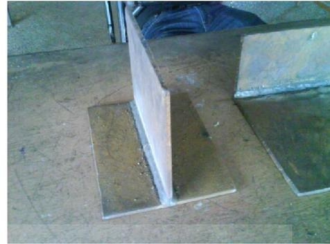
Gambar 3.15 Profil T Marine Buatan
