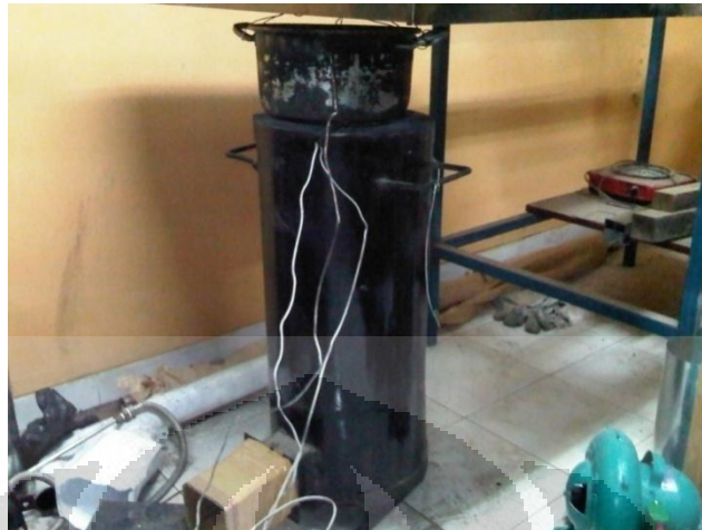
Gambar 3. 8 Kampor Briket yang Digunakan pada Penelitian dan Blower
