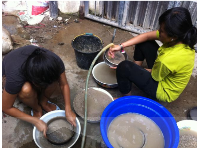
Gambar 4.1 Proses Penyaringan dan Pencucian Agregat
