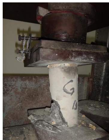
Gambar 4.12 Alat Uji Kuat Tekan (kiri) dan Proses Uji Kuat Tekan (kanan)
