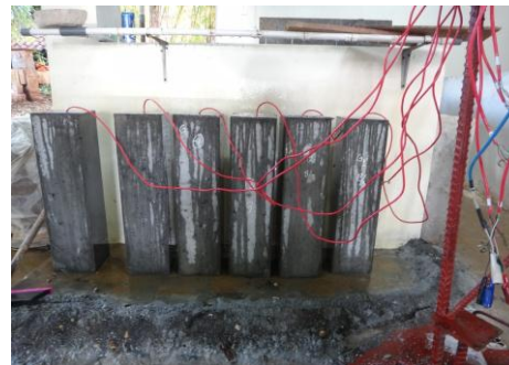
Gambar 4.10 Proses Perawatan Benda Uji untuk Balok
