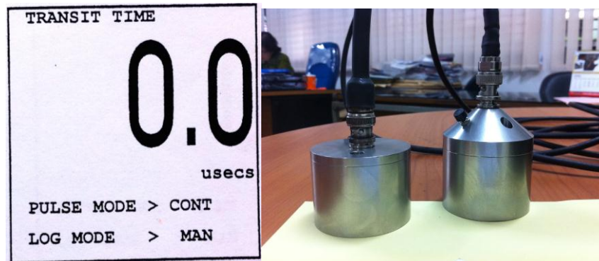
Gambar 4.16 Transit Time Screen (Kanan) dan Dua buah Sensor (kiri)
