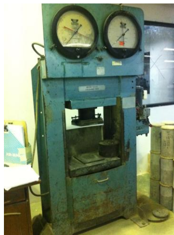
Gambar 4.12 Alat Uji Kuat Tekan (kiri) dan Proses Uji Kuat Tekan (kanan)
