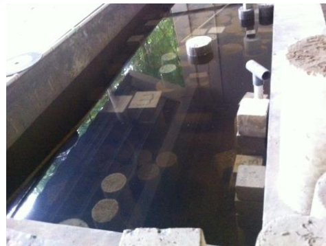
Gambar 4.9 Proses Perawatan Benda Uji untuk Silinder
