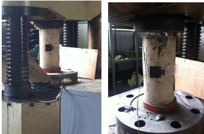
Gambar 4.23 Proses Uji Tekan Silinder Uji
