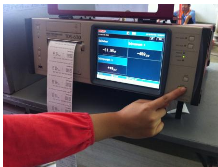
Gambar 4.24 Proses Pembacaan Regangan Pada Alat Output
