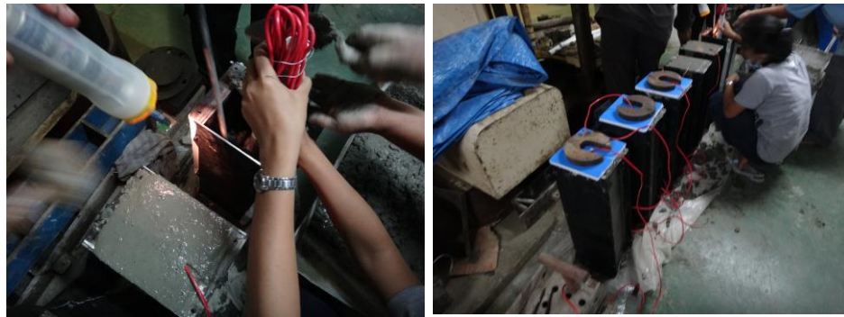
Gambar 4.8 Proses Pematatan Adonan Beton ke dalam Bekisting
