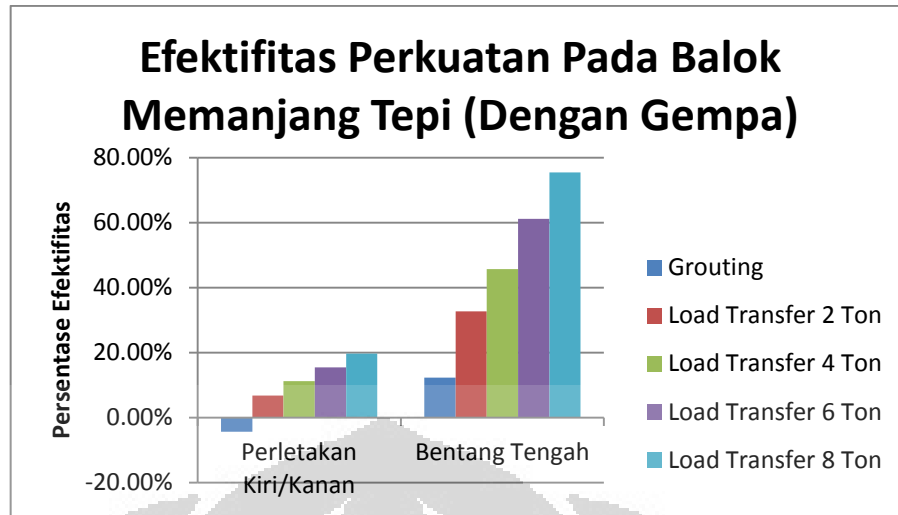
Gambar 4.15 Efektivitas Perkuatan Dalam Mereduksi Gaya Dalam Momen pada Balok Memanjang Tepi Akibat Beban Gravitasi dan Gempa (1.2DL + LL ± Gempa)
