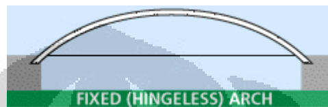
Gambar 2. 5 Jembatan pelengkung jepit
