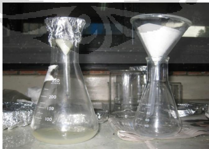
Gambar 3.5 Proses penyaringan sampel menggunakan corong dan kertas saring Whatmen 41
