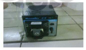
Gambar 3.9 Pompa peristaltik
