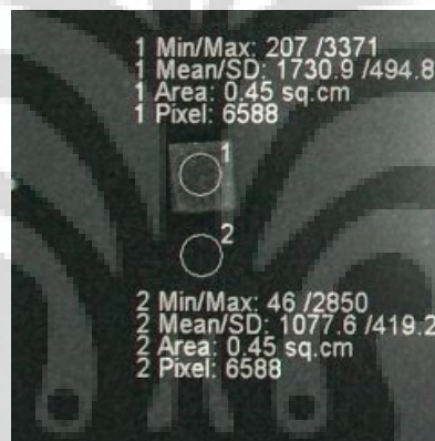
Gambar 4.11. Citra fantom dan objek kontras (diatas fantom) dan dilakukan ROI di dalam objek kontras (ROI 1) dan pada latar belakang citra (ROI 2); Citra ini diperoleh dari pengaturan 14 mAs
