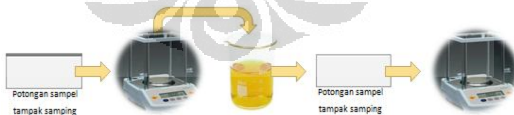
Gambar 3.12. Skema singkat cara menghitung berat lapisan elektro-galvanis
