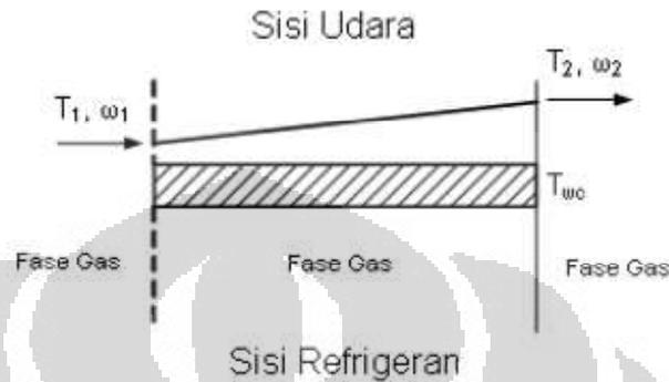
**Gambar 3.1 Skema Aliran Udara di Kondenser Kedua**
