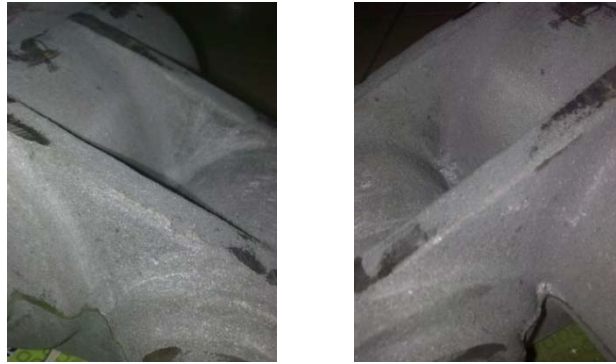
Gambar 4.7 Bagian benda yang dicurigai terdapat cacat saat simulasi (a. Bagian Kiri) (b. Bagian kanan)
