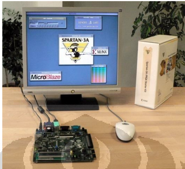
Gambar 2.7 Proses Download dari Komputer ke FPGA [9]
