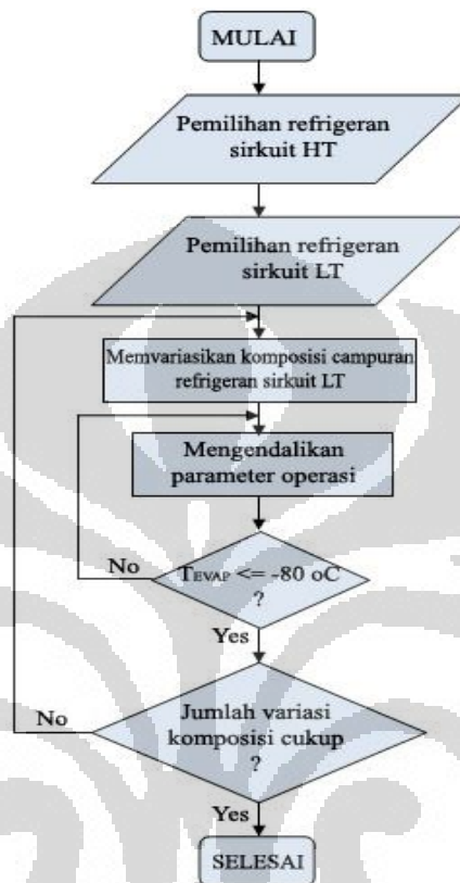
Gambar 3.4 Diagram alur proses simulasi sistem refrigerasi cascade
