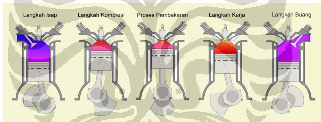
Gambar 2.2 Urutan siklus kerja motor bakar 4 langkah
