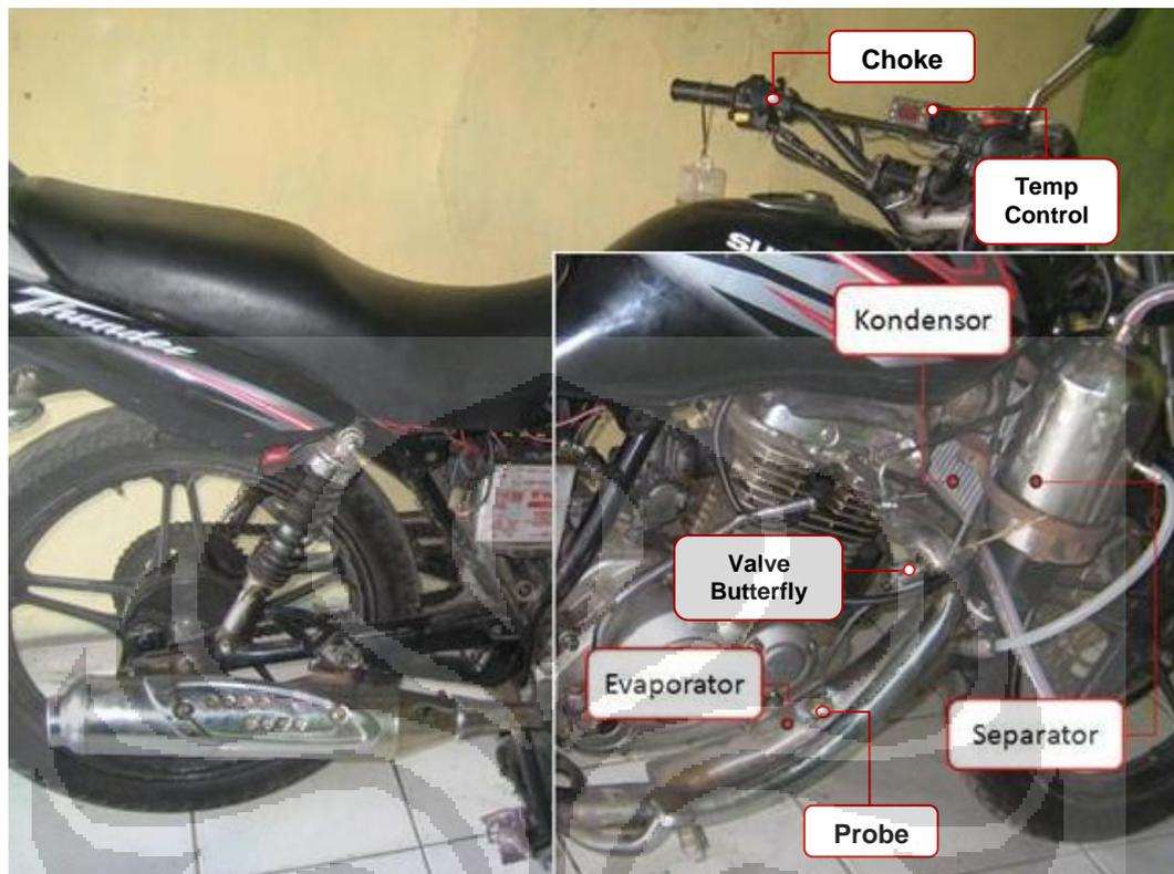
Gambar 3.2 Skema pengujian dengan compact destilator
