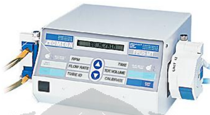
Gambar 4.3 Pompa peristaltik yang digunakan sebagai penyalur fluida.
