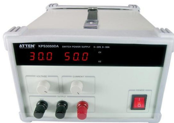
Gambar 4. 2 Power supply yang digunakan untuk memberikan tegangan pada differential pressure transmitter .
