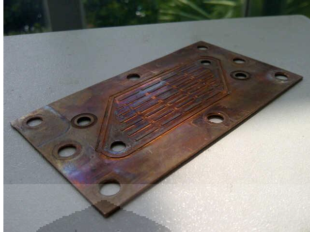
Gambar 3. 6 Bagian hot side dan end side yang terbuat dari pelat tembaga.
