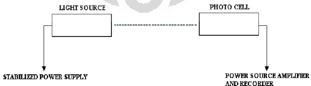
Gambar 2.5 Beam of light untuk mengukur optical density [8]
