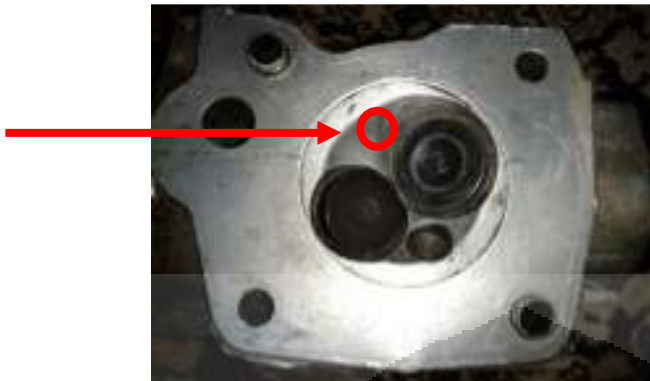
Gambar 3.3 Modifikasi Silinder Head Tanda merah menunjukkan tempat akan dipasang second spark
