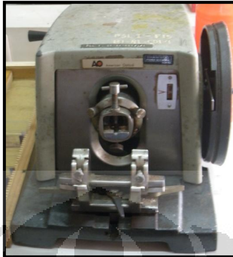
Gambar 3.5 Mikrotom yang Digunakan untuk Memotong Preparat Tulang dengan ketebalan 5-7 Mikron
