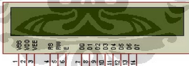
Gambar 2.20 Antarmuka LCD 16 x 2 [6]
