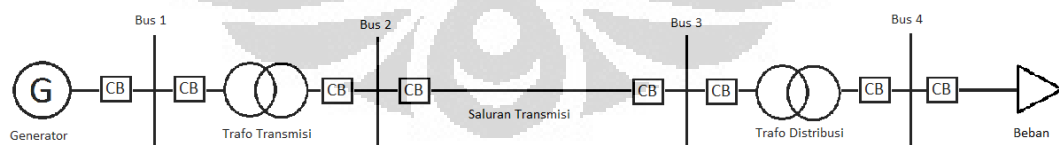
Gambar 2.4. Diagram satu garis sederhana sistem tenaga listrik
