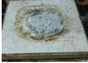
Gambar 3.4 Pengeringan Sol-Gel Menggunakan Heater
