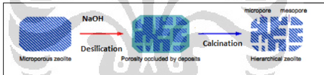
Gambar. 2.9 Skematik visualisasi pembentukan mesopori pada medium alkali
