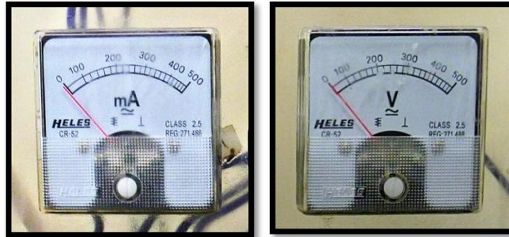
**Gambar 3.9** Amperemeter dan Voltmeter
