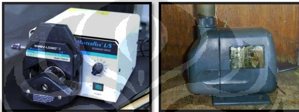
Gambar 3.3 Pompa Peristaltik dan Pompa Air
