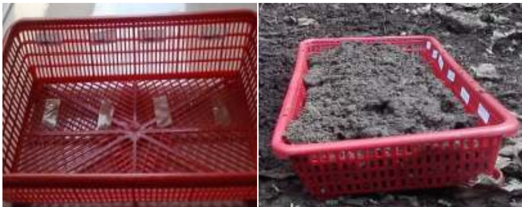
Gambar 4. 30. Ilustrasi Uji Biodegradabilitas dengan Metode Soil Burial Test
