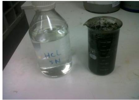
Gambar 4.5 Proses Pencucian karbon aktif dengan HCL 5N
