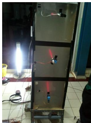
Gambar 4.12 ruang uji yang penuh dengan asap dan pengukuran oleh alat smoke detector
