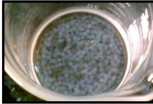
Gambar 4.11. Bead Ca-alginat yang terbentuk saat larutan alginat diteteskan ke dalam larutan \text{CaCl}_2
