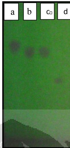
Keterangan: a. asam askorbat  $R_f = 0,75$ ; b. reaksi dengan sukrosafosforilase standar  $R_f = 0,72$ ; c. reaksi dengan sukrosafosforilase rekombinan  $R_f = 0,72$ ; d. AA2G  $R_f = 0,5$  menggunakan fase gerak butanol: asam asetat: air (3:1:1)
