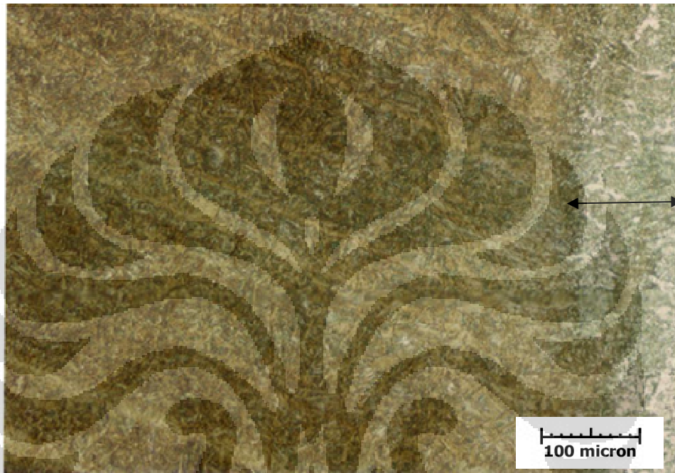
Gambar 4. 52 Mikrostruktur HAZ 1 sampel CR48-16-5-np
