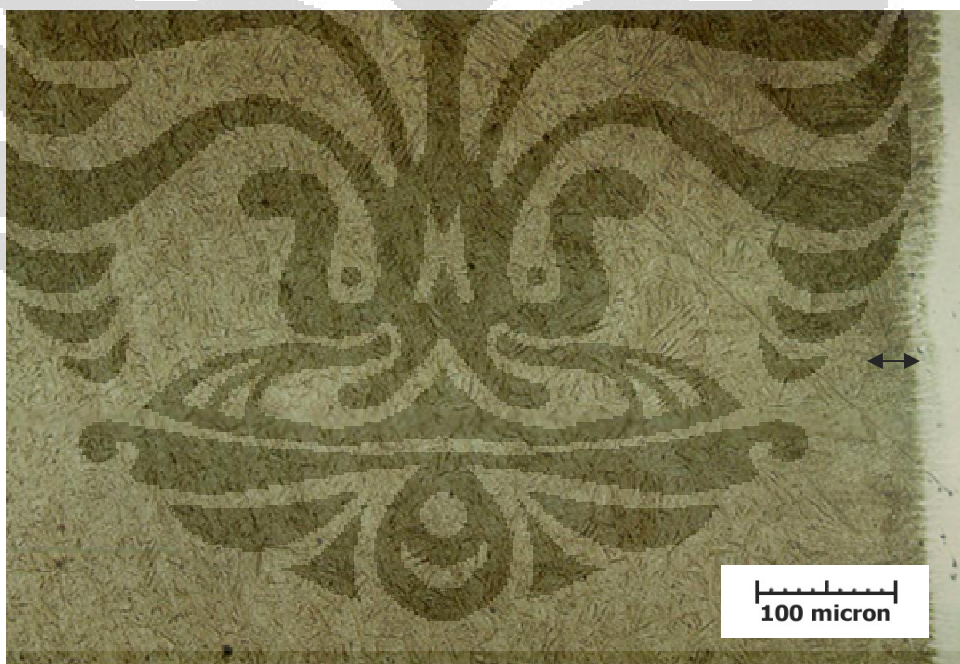
Gambar 4. 44 Mikrostruktur HAZ 1 sampel CR48-12-1-np
