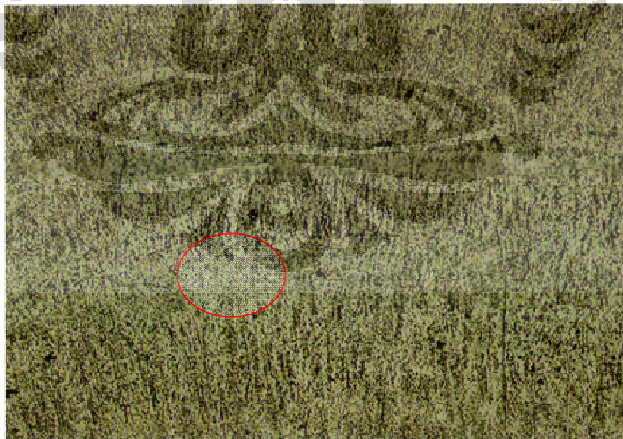
Gambar 4.33 Mikrostruktur Inti Las Elektroda MG NOX 35 sampel CR48-12-2-np
