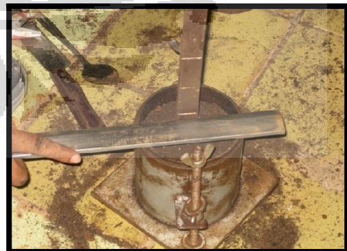
Gambar 12. Pengecekan Layer Compaction
