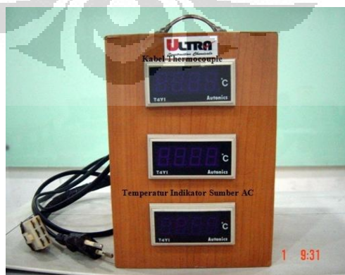
Gambar 3.4. Temperatur indikator sumber AC (Sumber : Ultrachem)
