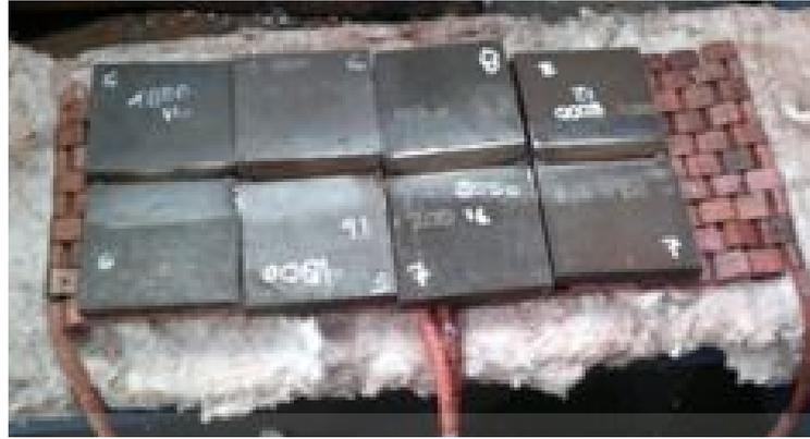
**Gambar 3. 3** Pemanasan awal dengan *Electrical Heater Elements*
