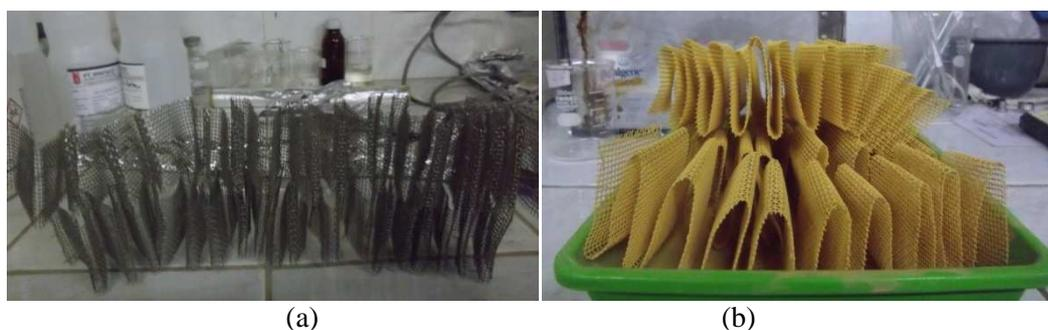
**Gambar 4. 8** Pelapisan katalis pada wiremesh (a) sebelum dilapisi (b) sesudah dilapisi
