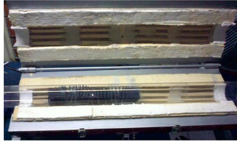
**Gambar 2.6** Reaktor berkatalis terstruktur untuk produksi CNT di DTK-UI (Francy,2009)
