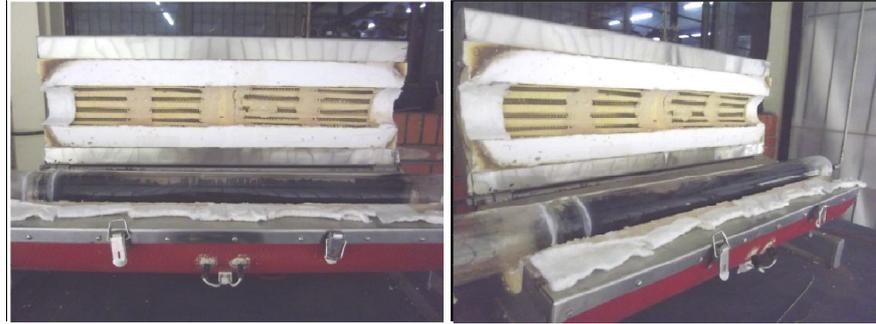
**Gambar 4.5** Kalibrasi laju alir umpan setelah reaksi saat reaktor berisi substrat katalis yang ditumbuhi oleh CNT
