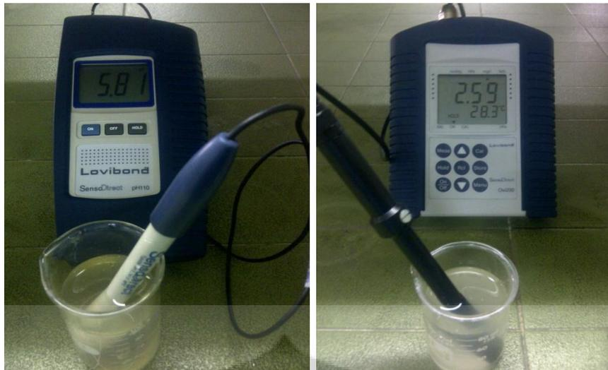
Gambar 5.4 Pengukuran pH Menggunakan pH meter (kiri), DO dan temperatur Menggunakan DO meter (kanan) Hari ke 18
