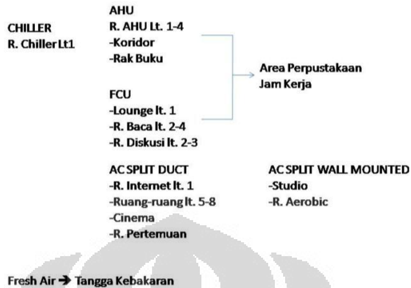
Gambar 3.10. Sistem pengudaraan pada perpustakaan pusat Universitas Indonesia (sumber : presentasi tim kontraktor 29 Maret 2010)
