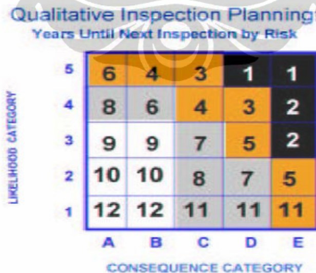
Gambar 3.5 Matriks interval waktu inspeksi berdasarkan tingkat resiko.
