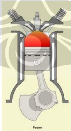
Gambar 2.3. Langkah kerja motor bakar bensin (Sumber: Shell Canada gasoline_engine)
