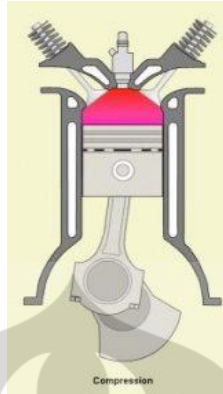
Gambar 2.2. Langkah kompresi motor bakar bensin (Sumber: Shell Canada gasoline_engine)
