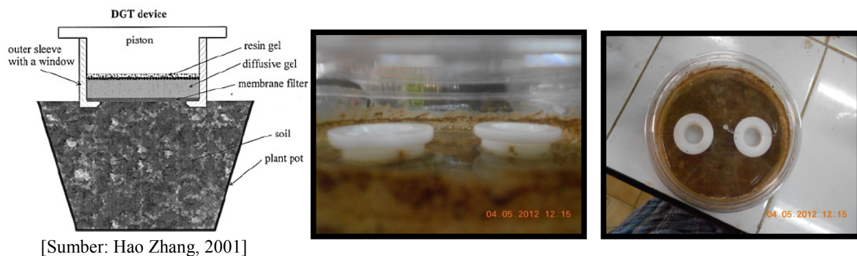
Gambar 4.11 Penggelaran DGT di Tanah
