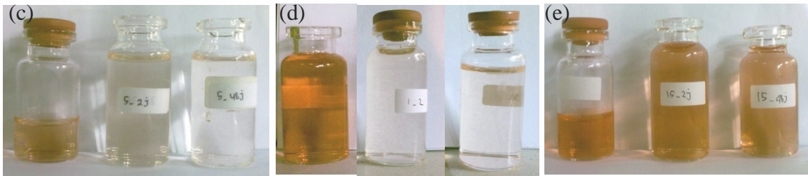
Gambar 4.13. Presentase degradasi Congo red secara fotoelektrokatalisis dengan variasi konsentrasi awal pada (a) Ti/TiO 2 (400°C/48 jam) (b) Ti/TiO 2 (650°C/2 jam) dan perubahan warna yang terjadi pada penggunaan konsentrasi awal sebesar (c) 5 ppm (d) 10 ppm (e) 15 ppm
