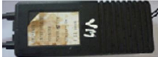
Gambar 3.12. trafo tegangan tinggi
