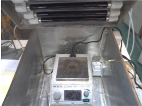
**Gambar C. 1** Reaktor untuk pengujian degradasi LAS.
