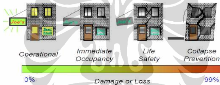
Gambar 2.1 Tingkat Kinerja Struktur Bangunan Menurut FEMA 356
