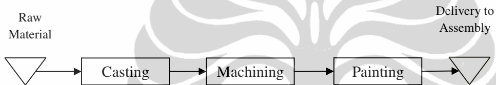
Gambar 3.4 Aliran Proses & Kapasitas Produksi Cast Wheel
