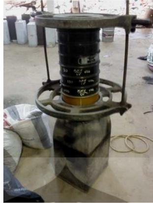
**Gambar 4.29** Pengukuran Sieve analysis
