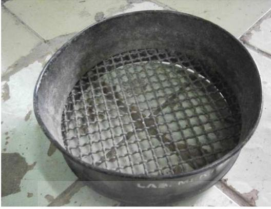
**Gambar** *Saringan untuk menguji WHC*
