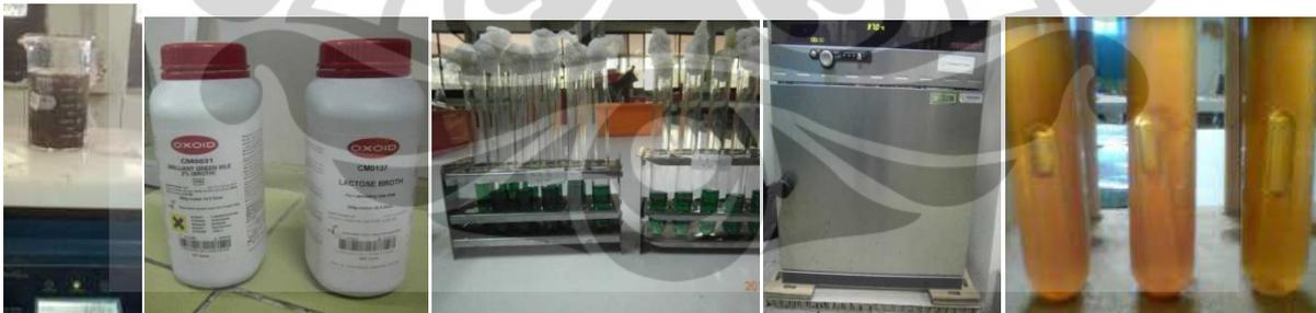
**Gambar** Pengukuran Fecal coliform (Kiri-Kanan: Sample yang diekstrak, medium LB dan BGLB, Inkubator, Tabung positif)
