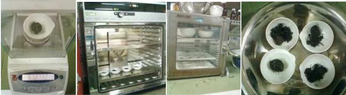
**Gambar** Pengukuran Kadar Air (Kiri-Kanan: Sample ditimbang, Sample masuk ke oven, Dimasukkan ke desikator, Sample ditimbang kembali)
