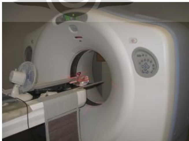
Gambar pengambilan data CTDI Phantom 10cm
